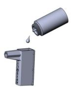
Versez la solution Native dans le réservoir par l'orifice prévu à cet effet. Attention : remplir jusqu'à la limite des renforts internes du réservoir (voir cidessous).
